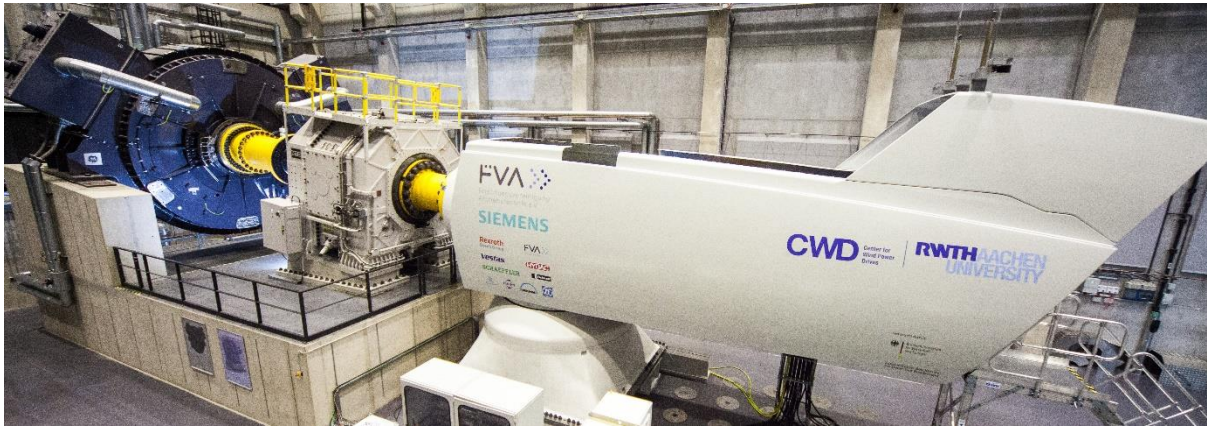
4 MW nacelle test bench with device und test
